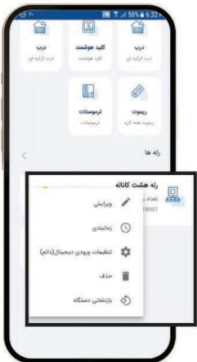
پس از اضافه نمودن دستگاه ۸ رله هوشمند، در صفحه لیست دستگاه مقابل نام رله آیکون () وجود دارد که با کلیک نمودن بروی آن صفحه، دستگاه ۸ رله هوشمند باز می شود در مقابل نام دستگاه ۸ رله هوشمند آیکون () قرار دارد سپس با کلیک نمودن بر روی آن صفحه تنظیمات رله همانند: ویرایش؛ زمانبندی؛ تنظیمات ورودی دیجیتال ( دائم )؛ حذف و بازنیشانی ( پاک نمودن دستگاه ) دستگاه باز می شود.
