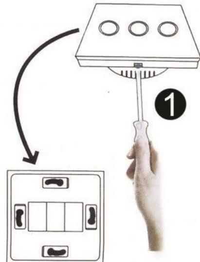
روش بازکردن پنل کلید
