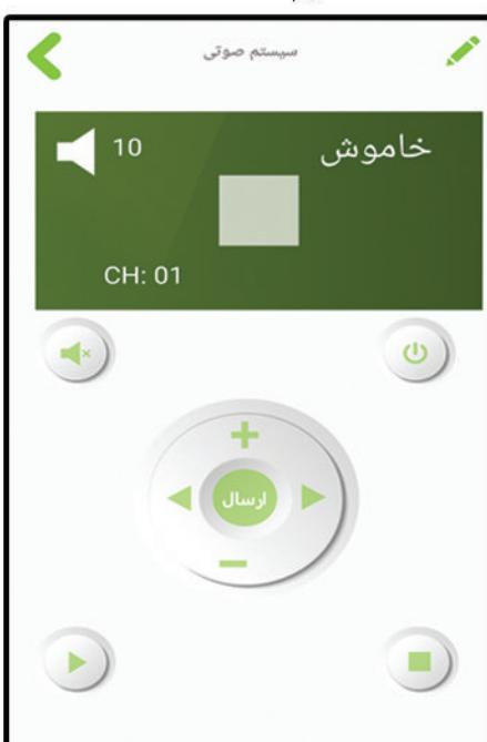
پس از فشردن دکمه Power داخل منوی سیستم صوتی App، چراغ قرمز ماژول شروع به صورت کند چشمک زده و کار ست کردن سیستم صوتی پایان می یابد
